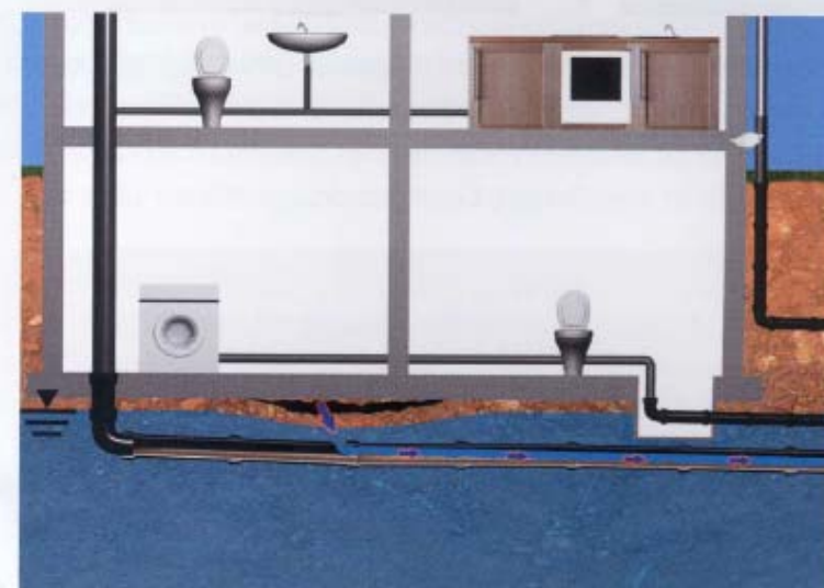
Infiltration: Grundwasser gelangt durch defekte Leitungen in das Kanalrohrsystem, Gefahr der Ausspülung von Boden und Bettungsmaterial unterhalb des Hauses
