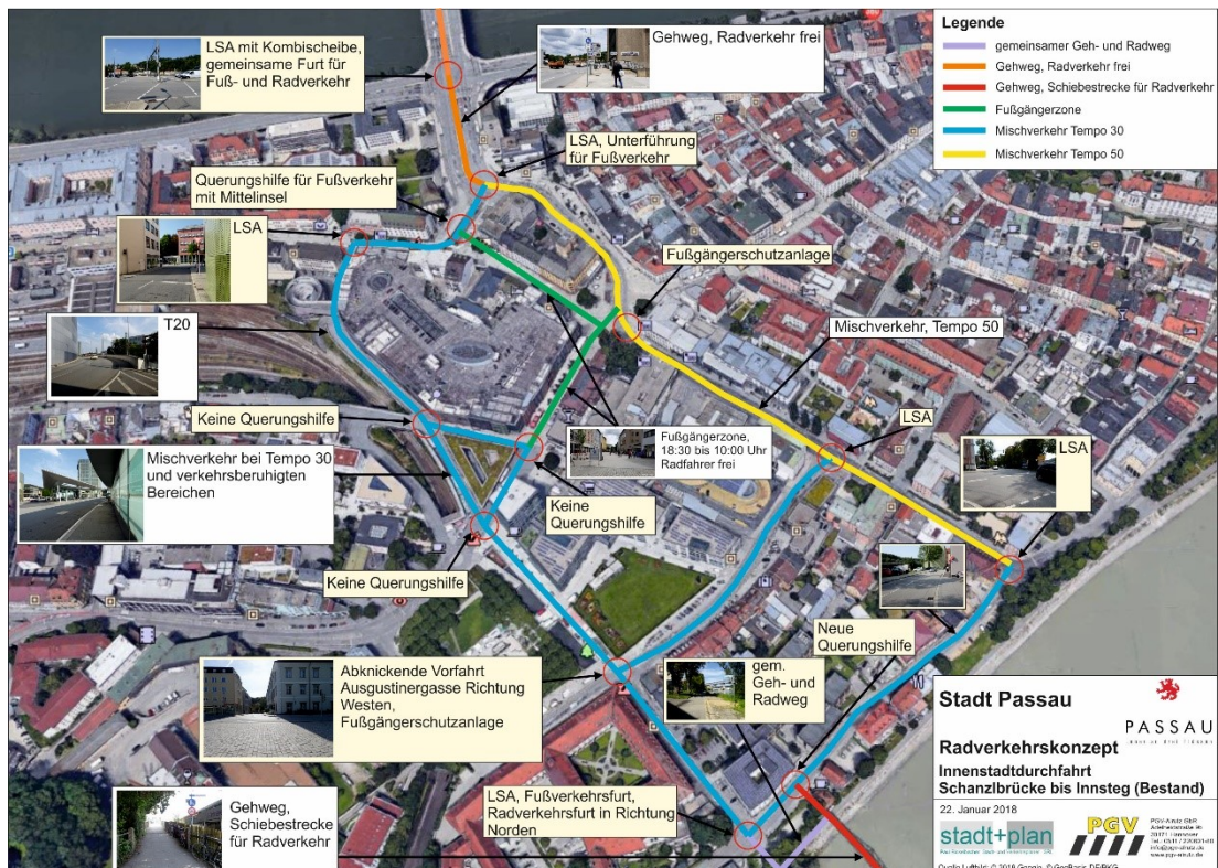
Abb. 6-37: Geprüfte Innstadtdurchfahrten zwischen Schanzlbrücke und Innsteg (Quelle Luftbild: Google Earth)
